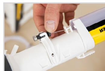
5. Coloque la manguera de bombeo de pintura sobre la tubuladura en a parte delantera.
