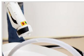
13. Al accionar el gatillo, mantenga la lanza pulverizadora encima del cubo de pintura y siga accionando hasta que salga pintura por la parte delantera.
