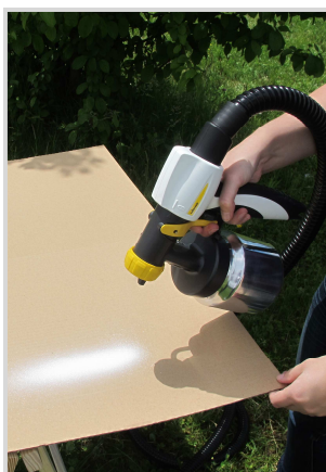
Jet vertical pour travailler de droite à gauche
