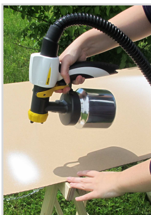
Jet de peinture horizontal pour travailler de haut en bas
