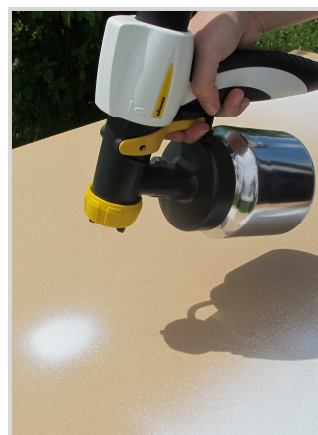
Jet ponctuel pour les travaux précis
