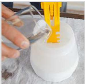
7. Mélanger vigoureusement la peinture et effectuer un essai de pulvérisation. Comme on utilise de la laque, faire glisser l'interrupteur en position 2. La position 1 serait correcte pour une lasure liquide.
