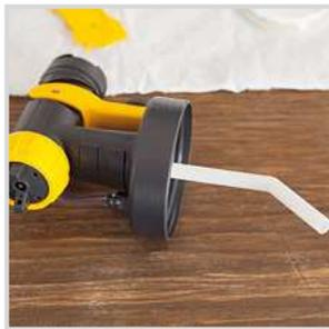
6. Remplir le récipient de peinture aux 3/4 avec de la laque et diluer celle-ci. Poser le mélangeur-agitateur au fond du récipient rempli. L'écart entre les encoches représente une dilution de 10 %. Vous trouverez des indications sur la dilution sur tous les pots de laque de différents fabricants, marqués avec le logo "Perfect Spray".
