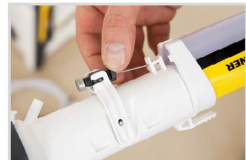
5. Enfoncer le tuyau flexible qui transporte la peinture sur le raccord situé à l'avant.
